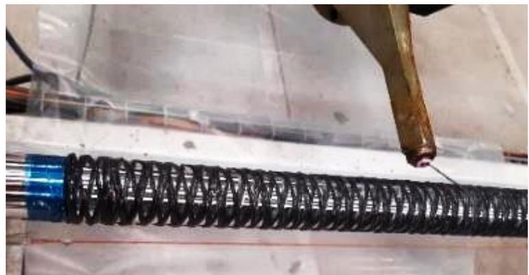
Figure 5 : Réalisation d'un enroulement filamentaire avec le fil recyclé
