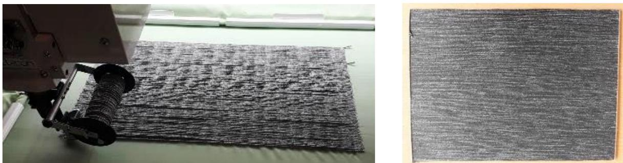
Figure 3 : Fabrication de la plaque composite Fil/Epoxy pour la caractérisation mécanique
