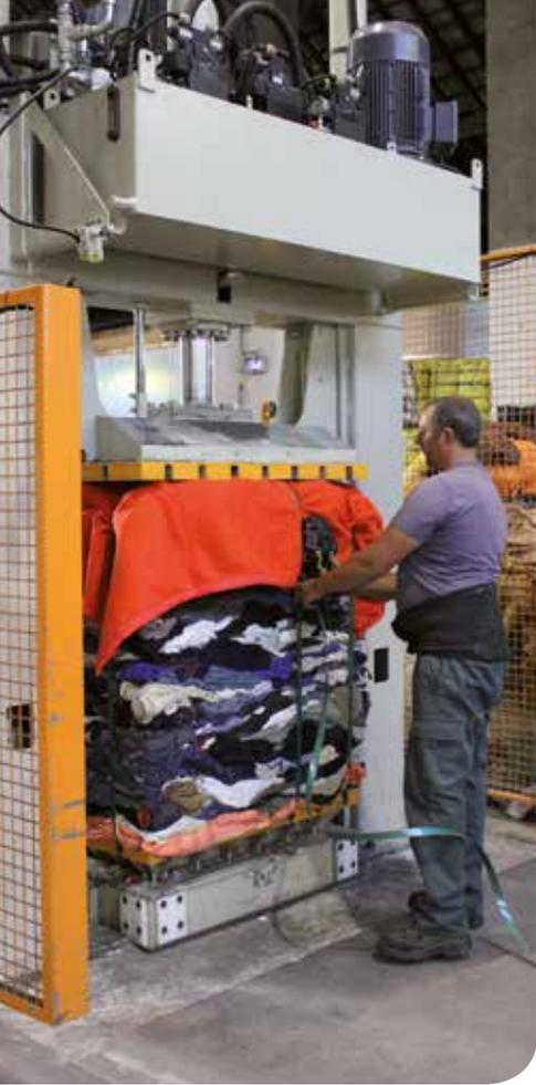
↗ Ballot de coton compacté avant d'être expédié vers l'usine d'isolant Métisse®
