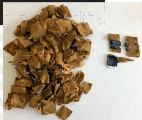
Découpe 60mmx60mm d'un T-shirt, permettant d'isoler celles comportant des garnitures.
