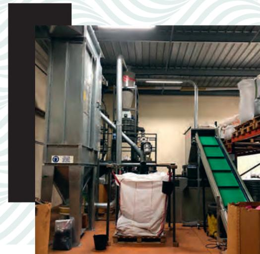
Régénérateur de granules de PVC recyclé issu des chutes de production de l'usine.
