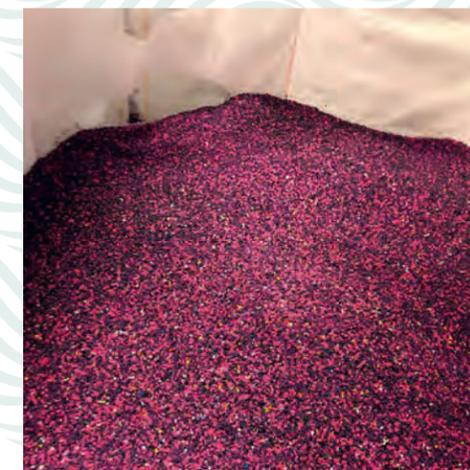
Granules de PVC recyclés.
