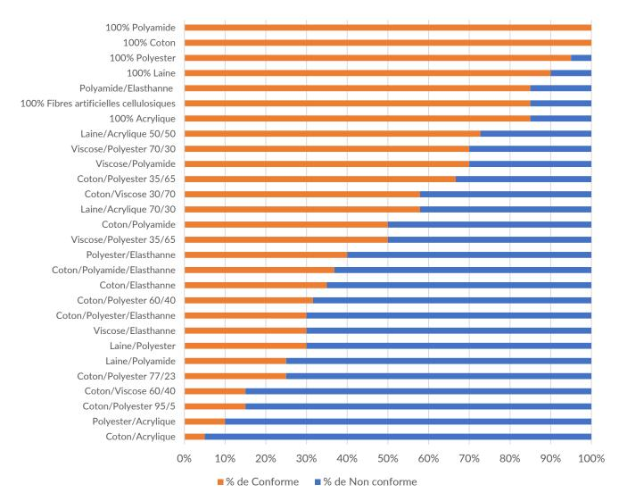
Figure 3 : Taux de conformité entre la composition annoncée par le fournisseur et le résultat de l'analyse laboratoire (20 échantillons testés par catégorie)
