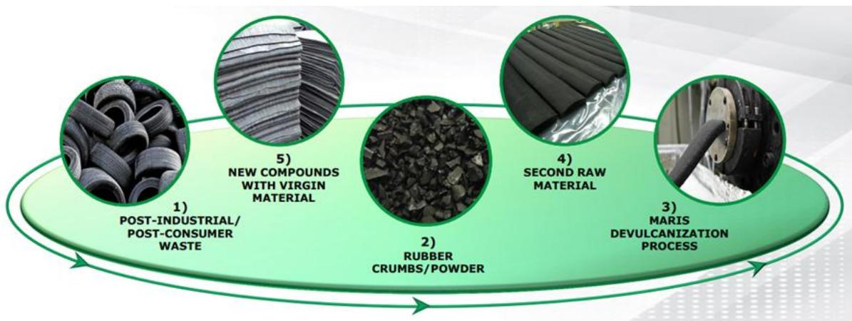
Figure 22 : Schéma d'intégration du process de recyclage de Maris (source mariscorp.com)
