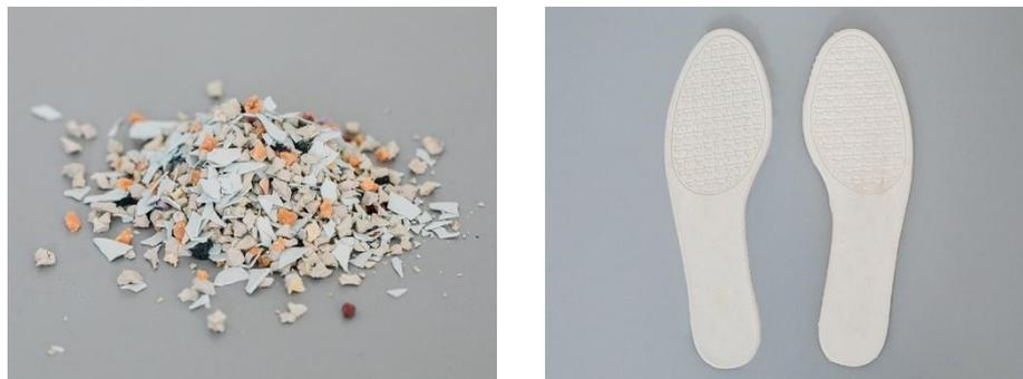
Figure 11 : Dévulcanisation du caoutchouc par Plymouth<sup>20</sup>
