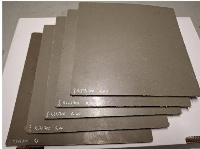
**Figure 36 : Plaques contenant différents taux de matière dévulcanisée (Elanova)**
