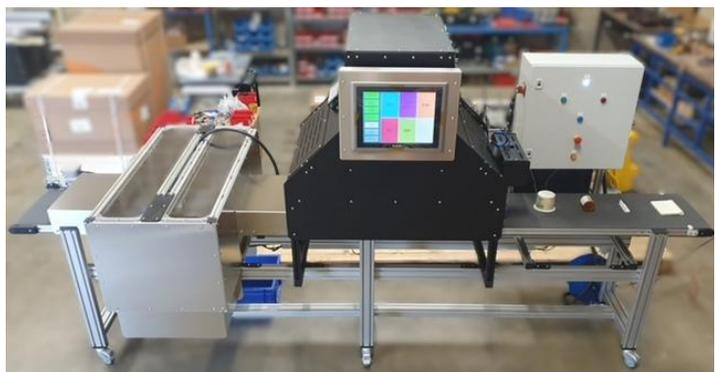
**Figure 5 : Ligne de tri par caméra hyperspectrale – Plas'tri<sup>16</sup>**
