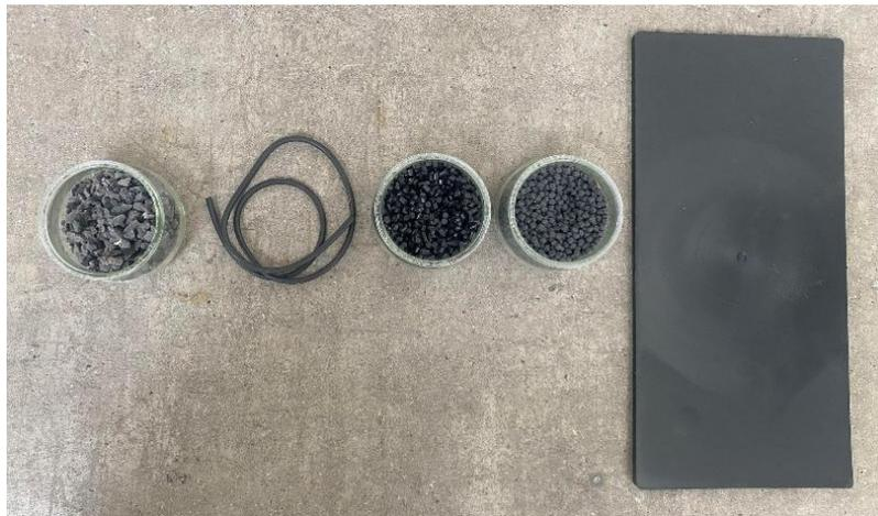
**Figure 29 : De gauche à droite : matière broyée, jonc d'extrusion, granulés recyclés, granulés vierges et plaque injectée contenant 50% de matière recyclée**
