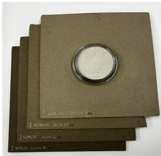
**Figure 33 : Caoutchouc micronisé (sur le dessus) et plaques contenant différents taux de caoutchouc micronisé**
