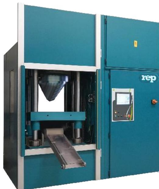
Figure 23 : Machine de dévulcanisation<sup>26</sup>
