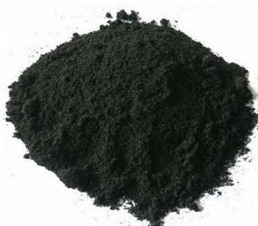
**Figure 7 : Caoutchouc dévulcanisé<sup>17</sup>**
