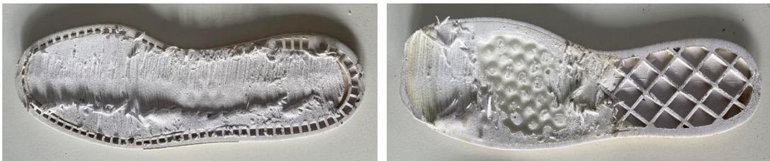
**Figure 41 : Semelle Caoutchouc/EVA/PVC (à gauche) et semelle Caoutchouc/EVA (à droite)**
