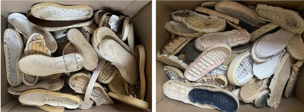
**Figure 40 : Semelles caoutchouc (à gauche) et semelles thermoplastiques (à droite)**
