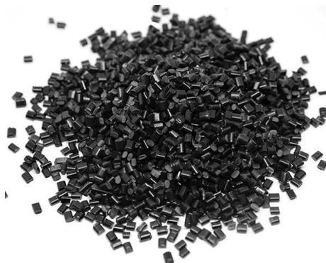
**Figure 19 : Compound produit à partir de caoutchouc de pneus**
